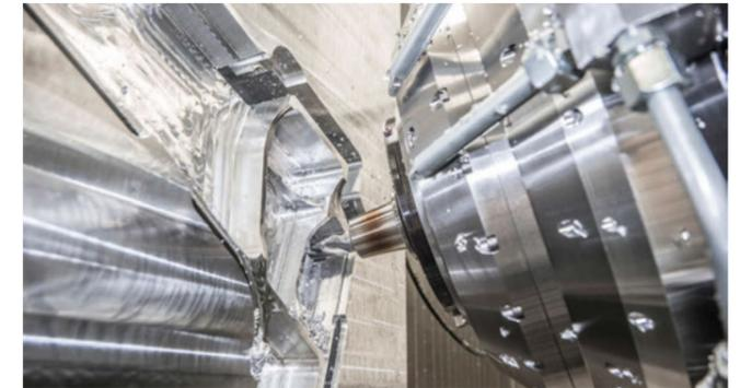
Ecospeed Bearbeitungszentrum mit 30.000 min<sup>-1</sup>, 120 kW, 6.300 mm (X) 2.500 mm (Y) 630 mm (Z)
