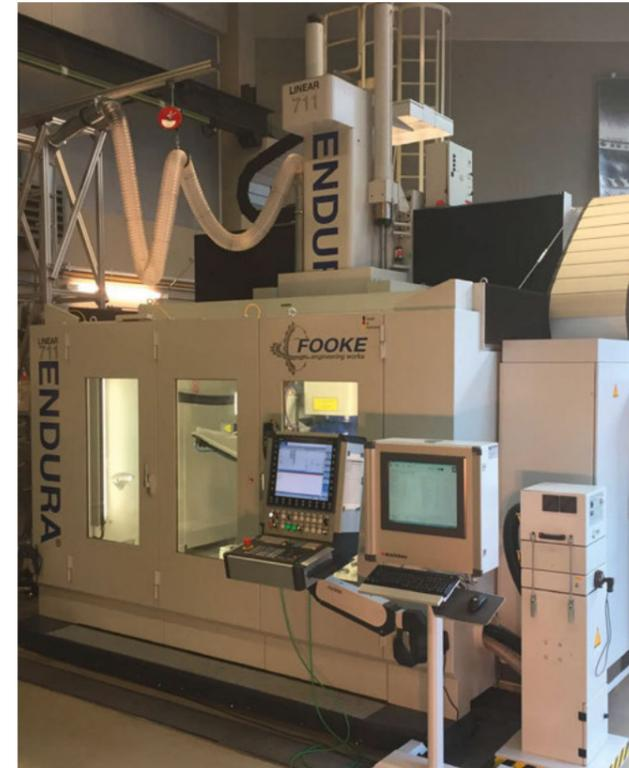
Bild 3: Demonstrator für die 5-achsige LSM-Bearbeitung von CFK-Luftfahrtbauteilen
