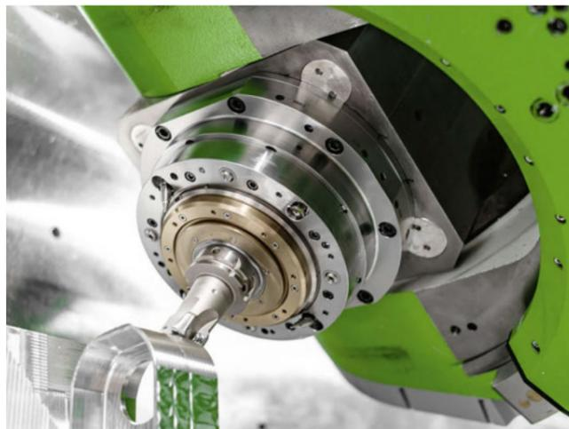
Für die Schrupp- und Schlichtbearbeitung von Strukturbauteilen aus Aluminium hat MAPAL neue Werkzeuge mit polierten Wendeschneidplatten entwickelt. (Bildquelle: F. Zimmermann GmbH)
