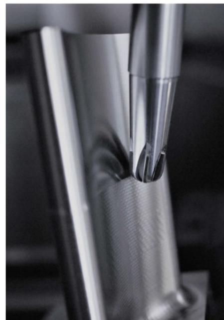
BL-PCBN (binder-less = gänzlich ohne Bindemittel) ist ein neu entwickelter Schneidstoff, der einen hohen Nutzeffekt und eine lange, stabile Standzeit bei der Bearbeitung schwer zerspanbarer Materialien wie Titanlegierungen, hitzebeständige Legierungen auf Ni-Basis und Co-Cr-Legierungen ermöglicht. SUMITOMO ist es gelungen, ultraharte Materialien vom Typ BL-PCBN namens NCB100 herzustellen, die unter sta-
