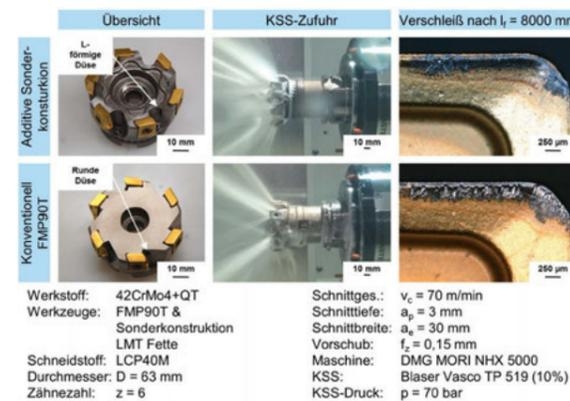
Konventionelles und additiv gefertigtes Messerkopfwerkzeug der Firma LMT Fette Werkzeugtechnik GmbH & Co. KG
