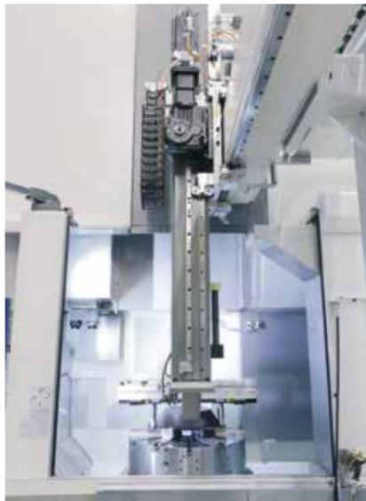
Blick in den Arbeitsraum der VTM 101 von ELHA MASCHINENBAU Liemke KG. Der RAM befindet sich zum Be- und Entladen der Werkstücke in sicherer Position.
