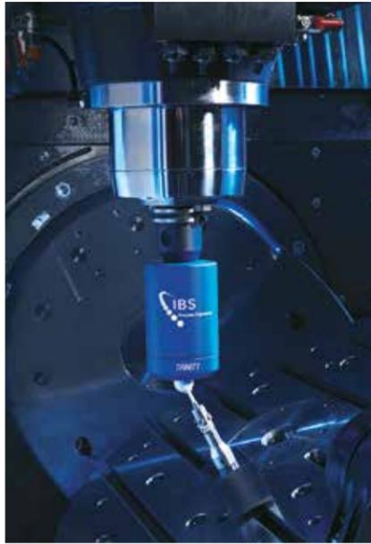
Rotary Inspector mit Trinity-Messkopf und Masterkugel
