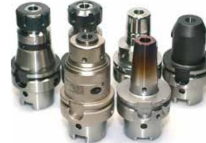
Abb. 1: Spannmittel für Zylinderschaftwerkzeuge
