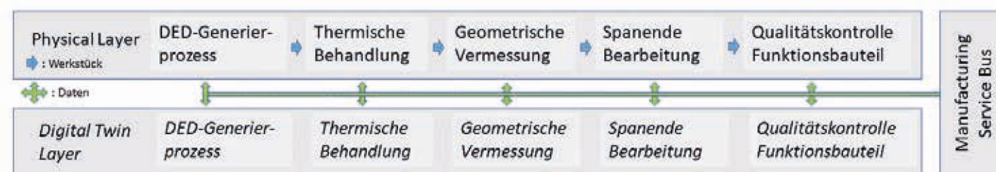
Abb. 1: DED-Prozesskette zur Herstellung von Funktionsbauteilen aus Titan
