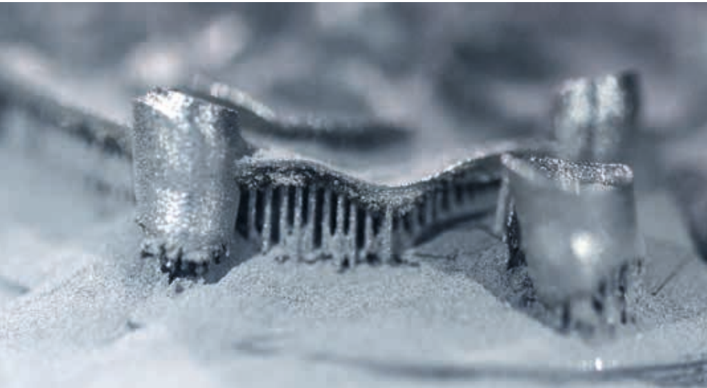
Nach dem Drucken fallen oftmals noch hohe und kostenintensive Aufwände am Bauteil an
