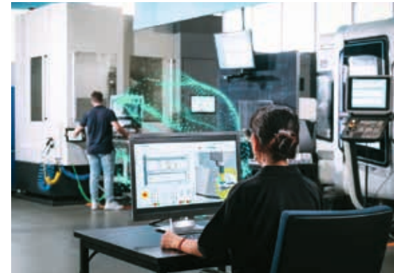
Mit dem digitalen Zwilling der Zerspanung, Run MyVirtual Machine, kann das NC-Programm virtuell am Computer simuliert, getestet und eingefahren werden
