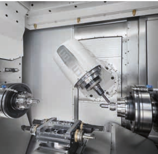
Hauptspindel an Gegenspindel im Innenraum der MT715
