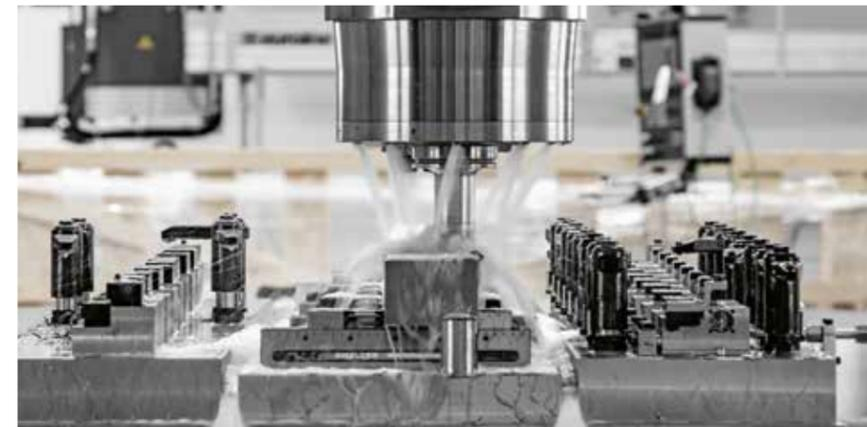
Durch das Expertenwissen aller Beteiligten konnten für die Titanbearbeitung übliche Werkzeugstandzeiten um das Siebenfache erhöht werden, bei gleichzeitiger Gewährleistung der Prozesssicherheit.
