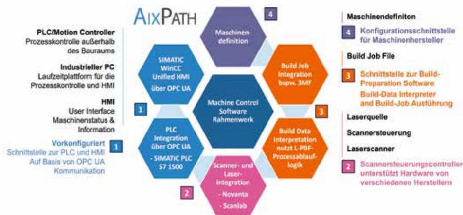
Die Machine Control Software (MCSW) ist ein neues standardisiertes Softwarerahmenwerk für Hersteller von Laser-Pulverbett-Systemen (L-PBF), welches von AIX-PATH entwickelt und bereitgestellt wird. MCSW bietet eine flexible und leicht erweiterbare Plattform zur Entwicklung von Steuerungssoftware für 3D-Drucker auf Basis eines OPC UA basierten Ansatzes zur Integration der Automatisierungs- und Di-
