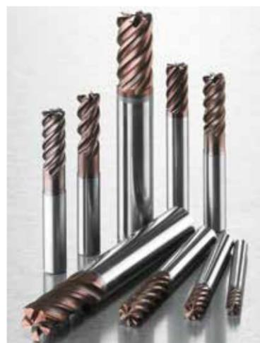
im Durchmesserbereich von 10-20mm und mit Eckenradien von 0,25-4,0mm verfügbar. Je nach Durchmesser werden die Werkzeuge mit 4, 5 oder 6 Schneiden angeboten, so dass in Abhängigkeit der Maschinenstabilität und Einsatzbedingungen immer ein Höchstmaß an Produktivität und Prozesssicherheit gewährleistet ist.
