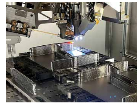
DED-Bauteil während des Druckens in der Kammer.
