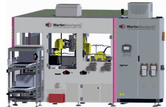
Die Fertigungsinsel MSB242812 für das Ummanteln von Bauteilen für das Management von Batterien
