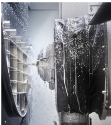
Der parallelkinematischen Bearbeitungskopf Sprint Z3 für effizienteste Bearbeitung von Aluminium-Strukturbauteilen.
