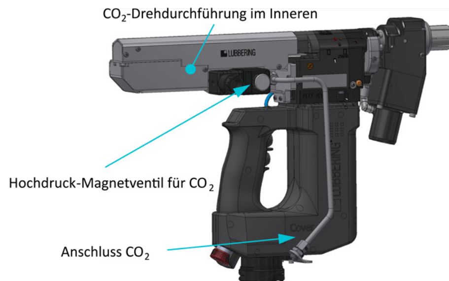
↑ Abbildung 2: Auf kryogene Kühlung umgerüstete ADU der Fa. Lübbeling GmbH.
