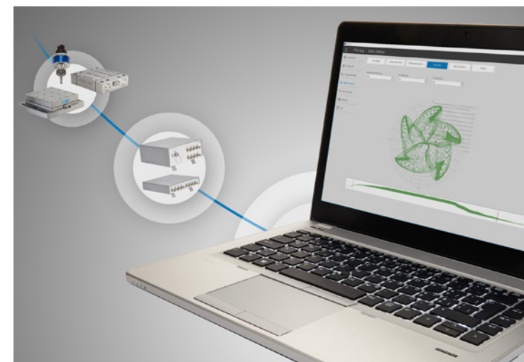
↑ Bild 2: In Forschung und Entwicklung kommen hochempfindliche Labor-Dynamometer zum Einsatz, deren Messdaten mit der PTS App visualisiert, analysiert und bewertet werden können.
